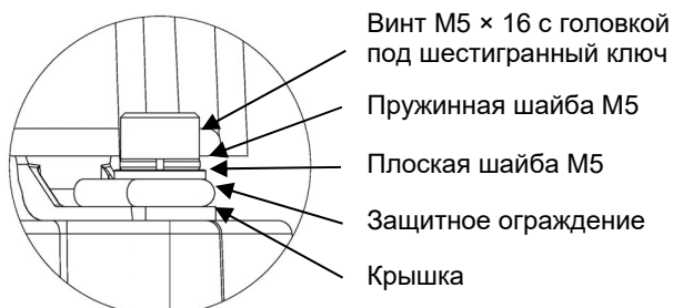
Рис. 13. Крепления крышки и защитного ограждения
