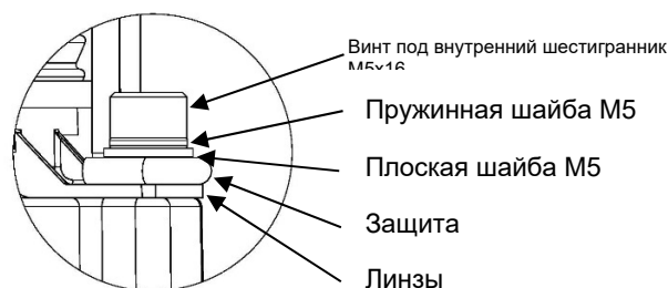
Рис 17. Порядок крепления линзы и защиты
