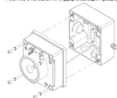
После того, как винты будут удалены, крышка отвиснет, чтобы получить доступ к клеммной колодке Ex e, внутренней клемме заземления и выемкам монтажного отверстия.
