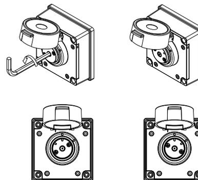
1. На управляемом устройстве поворотная кнопка против часовой стрелки на 55° положение
