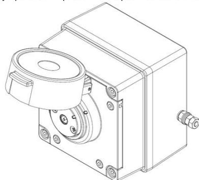
Используя специальный инструмент сброса, при условии, что кнопка сброса инструмента поворачивается против часовой стрелки на 55°, см. направляющие метки выравнивания на кнопке и крышке, показанные ниже (1). Кнопка сброса инструмента должна вернуться в исходное положение. Убедитесь, что кнопка сброса инструмента также повернута по часовой стрелке на 55° в исходное положение, см. направляющие метки на кнопке и крышке, показанные ниже (2). Теперь устройство сброшено.
