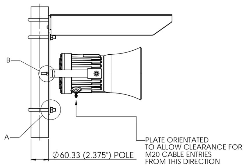
**GNExS1 SOUNDER / GNExL1 LOUDSPEAKER**
