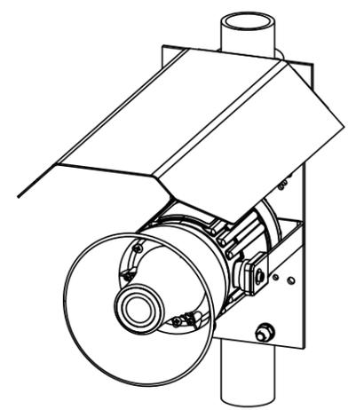
**GNExS2 SOUNDER / GNExL2 LOUDSPEAKER**
